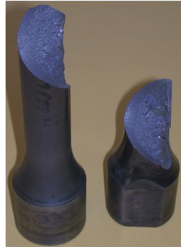
**Fig. 1** – **a** : craies soumises jusqu'à la rupture à des essais de traction pure (à gauche), traction-torsion en augmentant la torsion (en allant vers la droite), torsion pure (à droite). **b** : éprouvette en fonte soumise jusqu'à la rupture à un essai de torsion pure (Centre des Matériaux de l'école des Mines de Paris, source Forest 2009).
