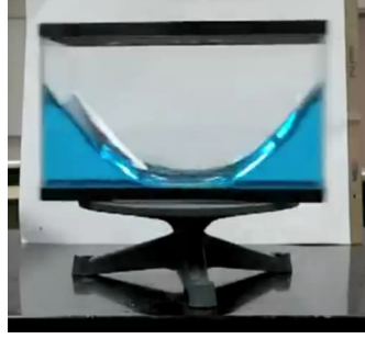
Fig. D.14 – Photographie extraite d'un film de Dan Russell sur YouTube [chercher 'rotating water container'], montrant la surface libre d'un liquide posé sur une table tournante.
